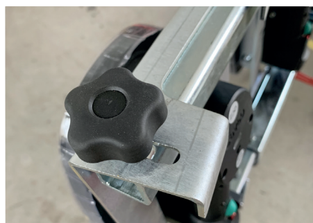
Äußere Verlängerungen können leicht gekippt werden, um gebogene Elemente aufzunehmen
