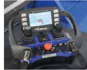
Elektronisches Lastbegrenzungssystem mit Display für die Anzeige der Last- und Jib-Position (LMI).
